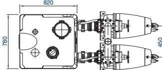
MULTILIFT MD1 – насосные установки с двумя насосами и двумя резервуарами
