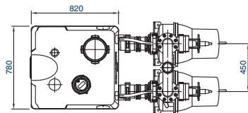
MULTILIFT MD1 – насосные установки с двумя насосами и двумя резервуарами
