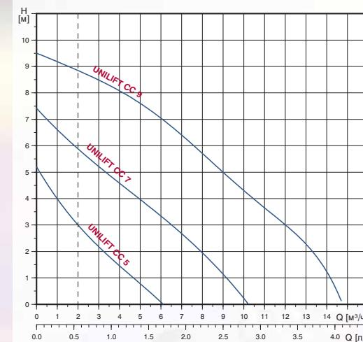
Пунктирная линия указывает минимальную скорость потока в 0,7м/с при напорном трубопроводе DN32.
