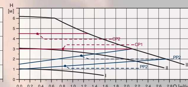
PP1, PP2 – кривая пропорционального регулирования с низким/высоким значением напора
