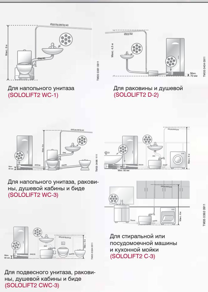
При монтаже насосной установки SOLOLIFT2 следует руководствоваться следующим:
