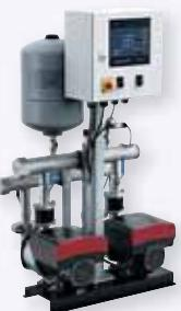
**Установка Hydro Multi** – бюджетное решение, идеальное в условиях дефицита площади. Компактная насосная станция повышения давления, укомплектованная двумя или тремя насосами СМ, СМВ, СМЕ, соединенными параллельно, установленная на общей несущей раме через виброзолирующие опоры.
