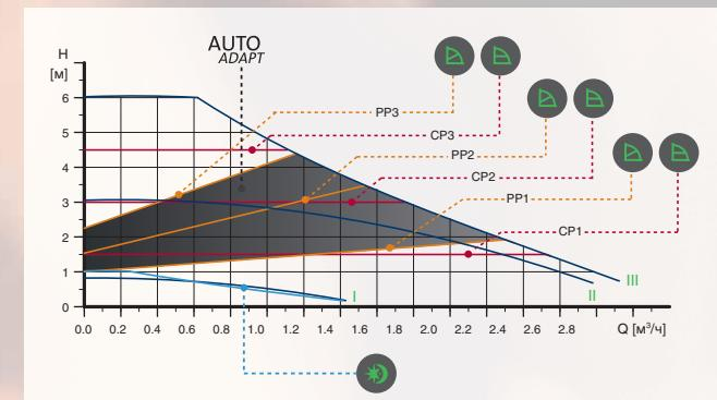
PP1, PP2, PP3 – кривая пропорционального регулирования с низким/средним/высоким значением напора
