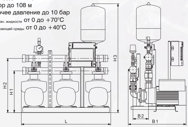
Установка Hydro Multi-E укомплектованная двумя или тремя насосами СМЕ позволяет автоматически регулировать производительность в зависимости от уровня потребления и поддерживать постоянное давление.
